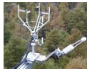
傾斜センサー取付例 2m 7- \mu m の先端、超音波風速計手前に取付
