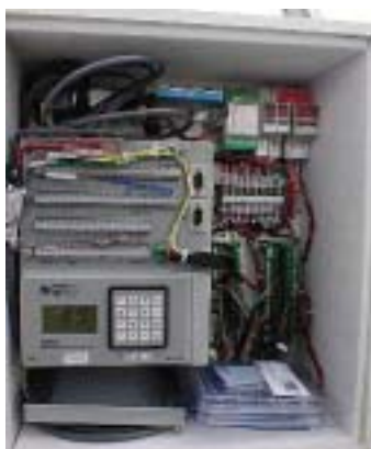
計測ボックスの内部の例 (C-CR5000)電源系は別箱
