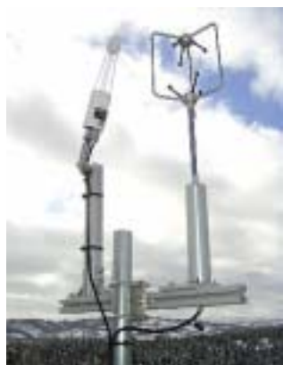
3成分超音波風速計と CO 2 /H 2 O オープンパスアナライザ
