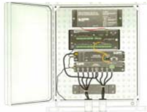
屋外用収納ケースにデータロガーシステムと C-SDMX50 を一緒に組み込んだ例
