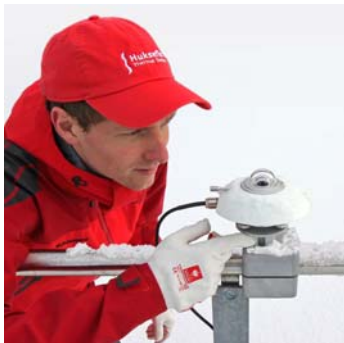
降雪直後の様子（ドームへの着雪が除去された状態）
