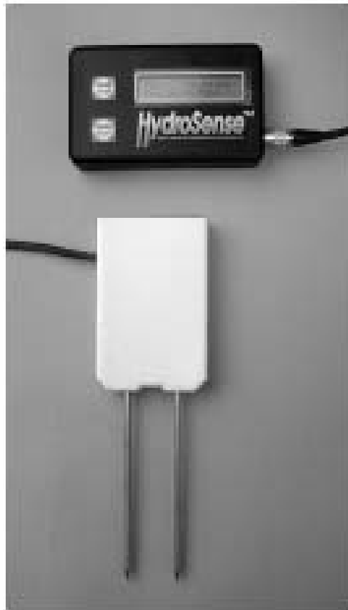
図 水分センサー ディスプレイユニットと12cmのロッド
