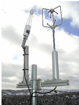
3成分超音波風速計と CO 2 /H 2 O オープンパスアナライザ
