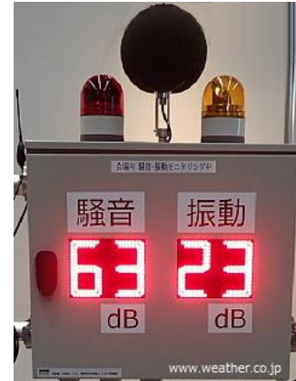
ウェザーチェック 騒音振動モニターシステム
