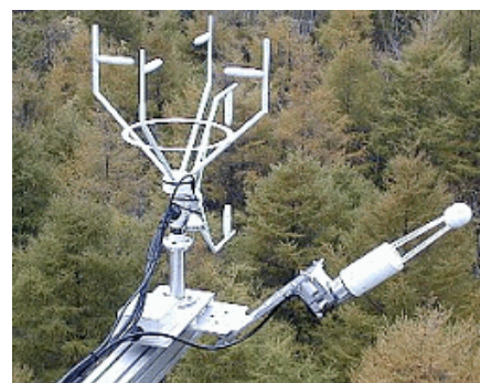
傾斜センサー取付例 2mアームの先端、超音波風速計手前に取付
