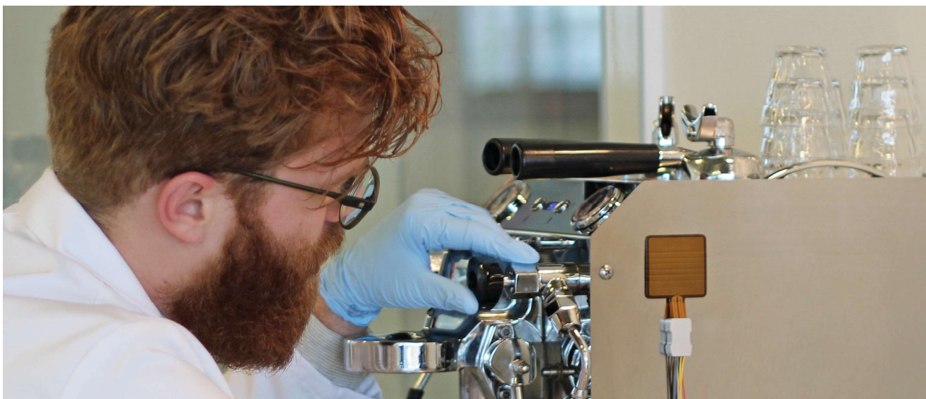
図1 エスプレッソマシン金属表面の熱損失を調べるための熱流計
